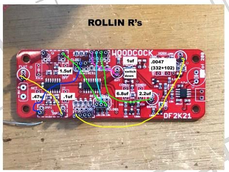
ROLLIN' R'S SET (.047 uf) Dee1 IT (10 uf) FLUT OFF (15 uf) CLOQ1 XTRA (.1 uf) CLOQ2 QA1 RHY QB1 Dee2 QC1 BRANE QD1 **BRAIN** 1u—10uf 1 uf CONDU left 6.8 uf CONDU right 2.2 uf .0027 uf
