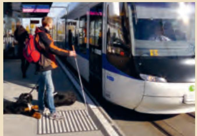
Die Einstiegsposition an Haltestellen wird kontrastreich gekennzeichnet. Auf hellen Belägen wird der Kontrast mithilfe eines dunklen Primers erreicht.
