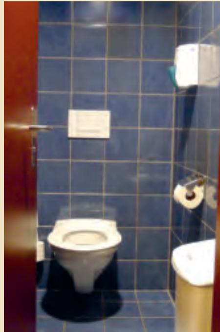
*Kontraste zwischen Apparaten, Bedienungselementen und deren Hintergrund erleichtern das Auffinden.*
