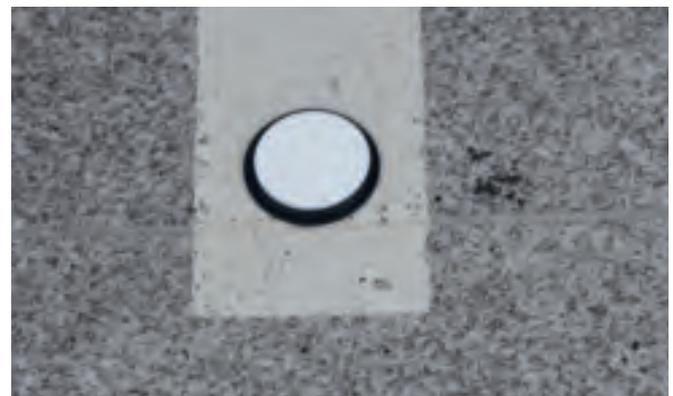
*Mit der Reflexionsnormalen, einer Fläche mit einem definierten Reflexionsgrad, kann durch eine Vergleichsmessung der Reflexionsgrad  $\rho$  einer beliebigen Fläche ermittelt werden.*
