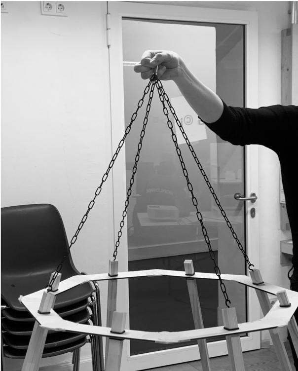
Um eine barrierefreie Betrachtung des Innenlebens des Ameisennest zu gewährleisten, konstruierten wir eine Aufhängung. In vier Holzstäbe wurden Haken hineingeschraubt, Ketten hineingefädelt und somit an der Decke befestigt.
