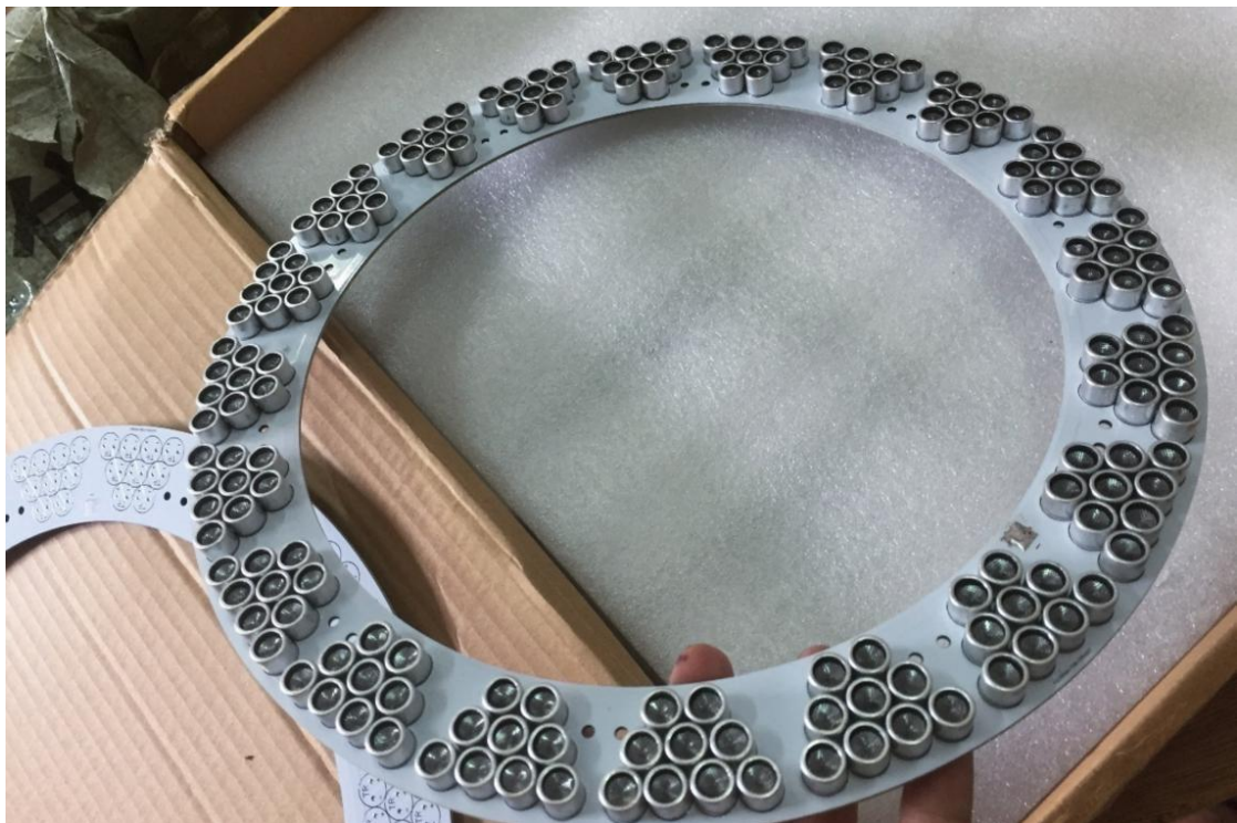
《心靜自然涼（空總）》，匹配天花板電風扇尺寸而設計的指向性喇叭模組，2020。
