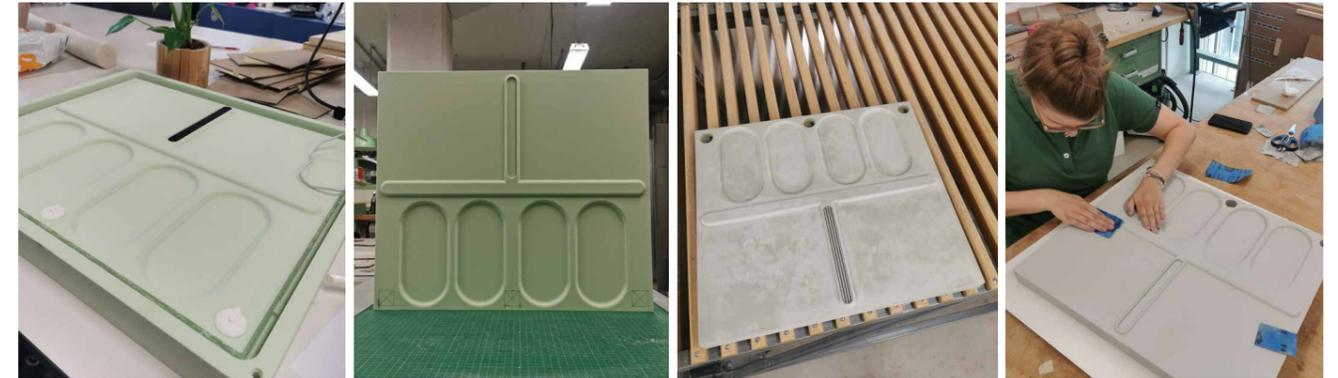
Schließlich folgte die Lackierung in seidenmattem Weiß. Die Schüsseln, der Kochtopf, die Knöpfe und das Gitter wurden im 3D-Druck hergestellt. Die Knöpfe sind mit Push-to-open-Mechanismen ausgestattet. Alle 3D-Druckteile wurden mehrfach abgeschliffen, mit Spritzspachtel grundiert und lackiert. Das Gestell wurde auf Gehrung zugeschnitten, verschraubt und gestrichen. Bei vielen dieser Schritte erhielt ich fleißige Hilfe von meiner lieben Kollegin Jeanine und meinem Freund Cliff.
