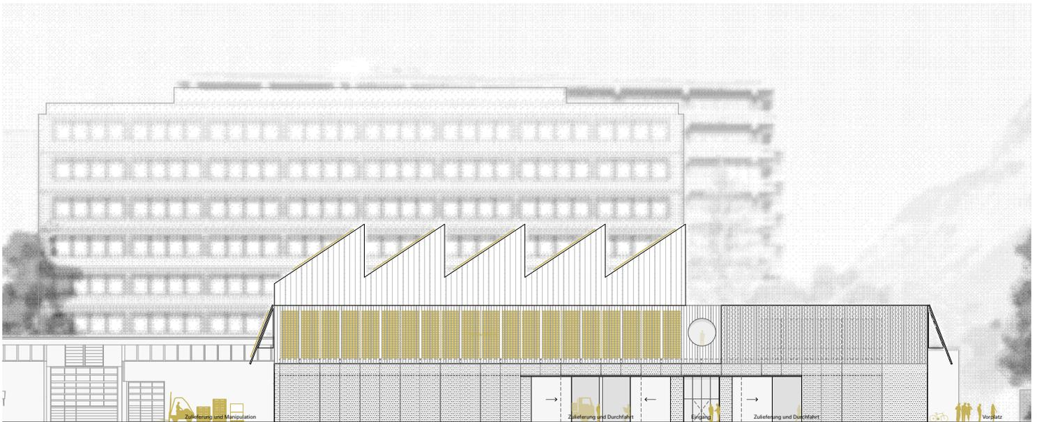
Nach Innen hin erscheint das Gebäude als lichte, offene Holzbox. Nach außen hin zeigt sich die Halle als in drei Ebenen gestaffeltes Volumen mit einem metallischen Kleid aus 100% recyclefähigem und korrosionsbeständigem Aluminium.
