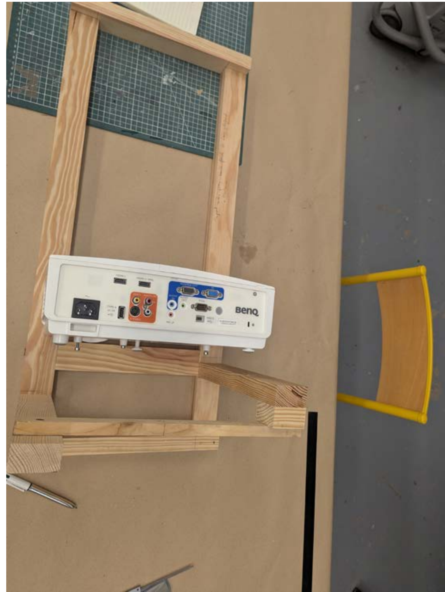
Amélioration d'une structure en vue de suspendre un vidéo projecteur
